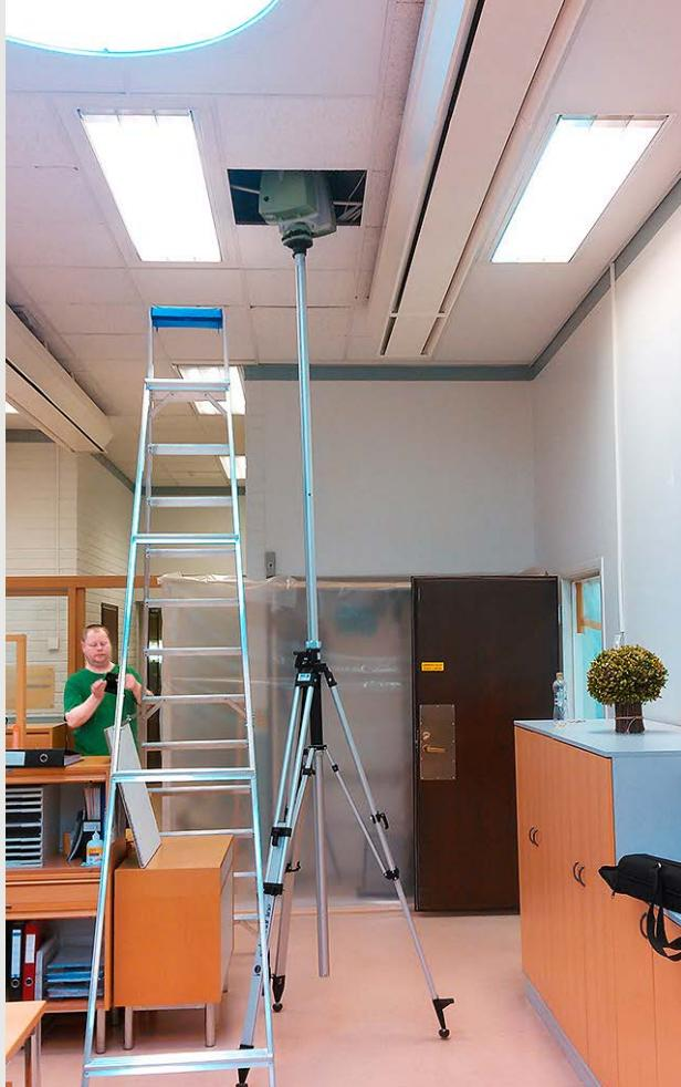
**Bild 4.** Laserscanning av konstruktioner ovanför innertaket i fastigheten på Skolhusgatan 26. Dessa data kan visas i samma koordinatsystem som övrig mätinformation. På bilderna syns en modell för visning av punktmolnsinformation.
